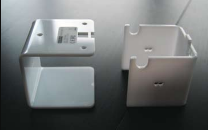
Die AudioCubes bestehen aus zwei U-förmigen Teilen, die ineinander greifen.
